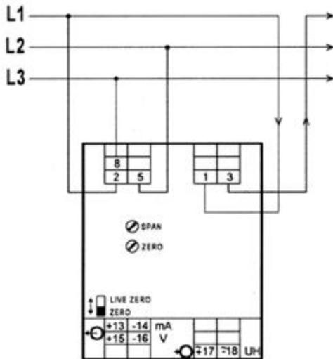
Bei Geräten mit Frequenzmodul entfallen weitere Ausgänge. An den Klemmen +13 und -14 steht der Frequenzausgang zur Verfügung
