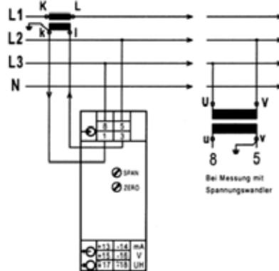
Arbeitsspannung bis 600V (Phase zu Neutralleiter L - N)
