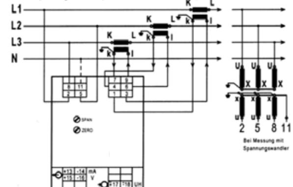
Bei Geräten mit Frequenzmodul entfallen weitere Ausgänge. An den Klemmen +13 und -14 steht der Frequenzausgang zur Verfügung.
