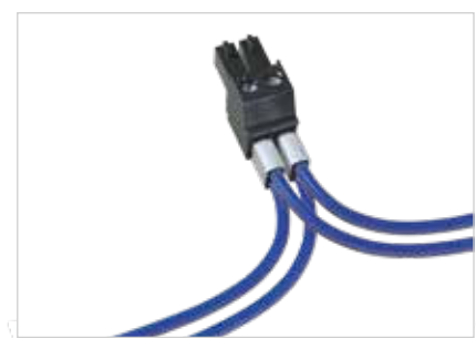
Abb.: 2-poliger Steckkontakt mit Kabelanschluss (Kabeltyp: 2 x 0,75 mm 2 ) über Twin-Aderendhülsen
