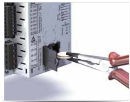
Abb.: Batterieaustausch mit einer Spitzenzange
